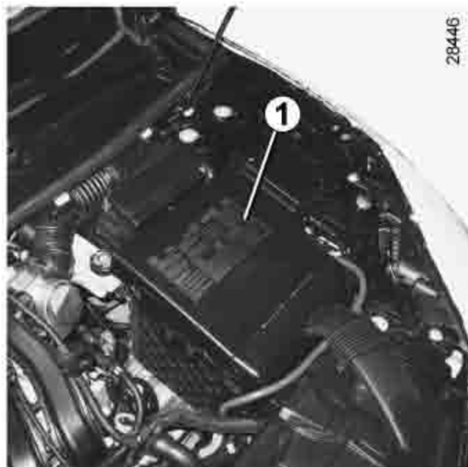
Аккумуляторная батарея 1 не требует специального технического обслуживания.
